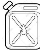
YAĞ VE YAĞLAMA BİLGİLERİ LUBRICATION INFORMATION 13LT SHC 626 MOBİL DEĞİŞİM SÜRE: 9 AY VEYA 1560 SAAT
