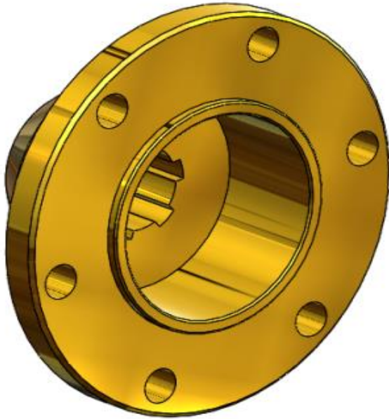
1.12.60 \phi 100 6x21x25 6 DELİK 019 UZUN KAPLİN/COUPLING
